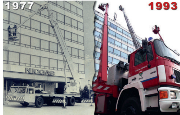
Die neue Teleskopmastbühne löst den ausgedienten Hubsteiger ab.
