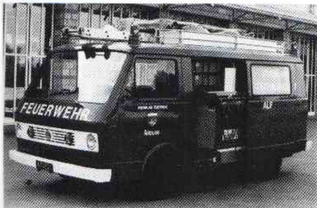
Atemschutzfahrzeug mit Chemieschutzausrüstung
